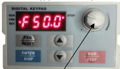
TYP A Potenciometer POT na externom paneli
